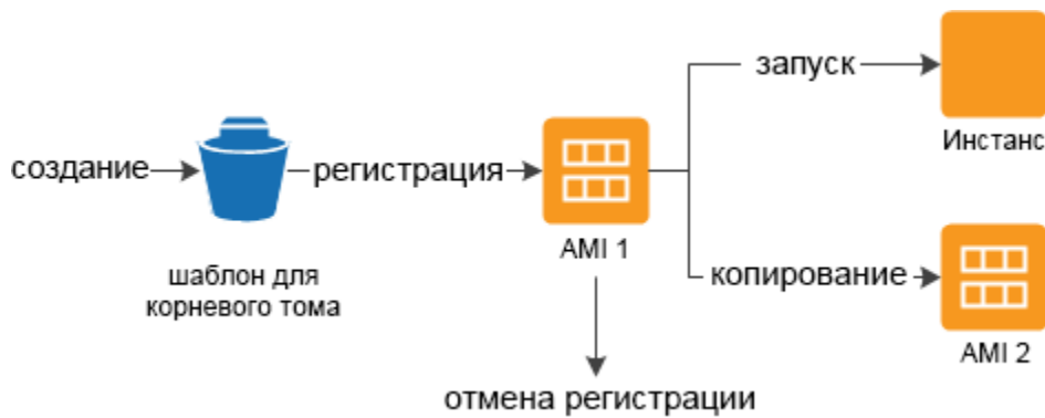
Рис. 3. Использование AMI для резервного копирования и запуска инстанса
