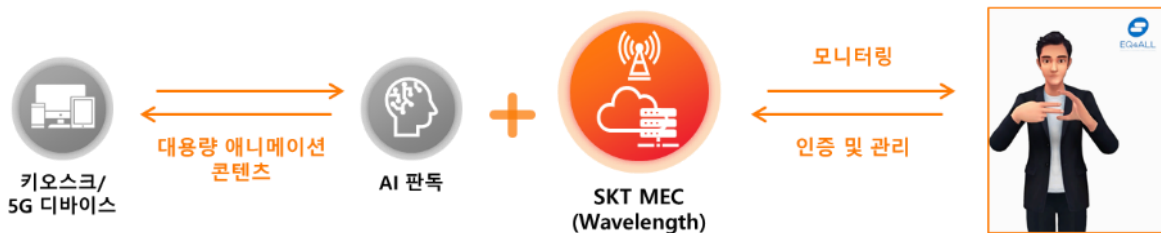
[그림 2-1-14] AI 기반 수어 번역 서비스 MEC 적용 구조도
